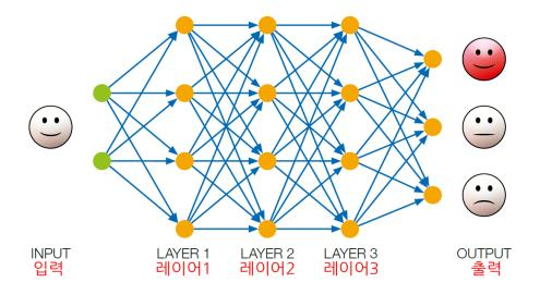
인공 신경망은 구조적으로 여러 레이어의 노드(뉴런)들로 구성되며 각각의 노드들은 다음 레이어의 노드들에 연결됩니다. 첫 번째 레이어는 입력 레이어, 마지막 레이어는 출력 레이어이고, 중간 레이어는 숨겨진 레이어로 불립니다. 대략적으로 신경망이 작동하는 방식은 뉴런 간 연결 각각에 가중치가 부여되고 이 가중치는 원하는 출력과 입력이 일치할 때까지 조정되는 것입니다. 각 출력 뉴런은 출력이 입력과 얼마나 일치하는지에 대한 확률을 나타냅니다. 위다이어그램은 ANN에 서로 다른 행복한 얼굴, 슬픈 얼굴, 중립적인 얼굴을 연달아 제시하면서 학습시켰습니다. 행복한 얼굴을 제시하면 출력에서도 행복한 얼굴을 나타내는 상황에 도달할 때까지 각 얼굴은 어떤 방식으로든 가중치를 조정합니다.
